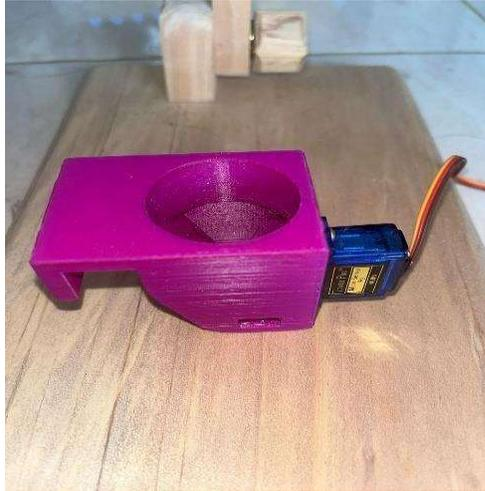
**Gambar 3.3** Cetakan 3D dengan Servo
