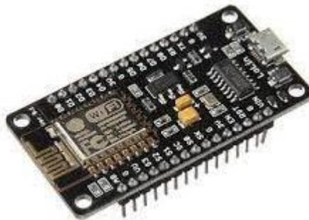
**Gambar 2. 4** NodeMCU V3.
