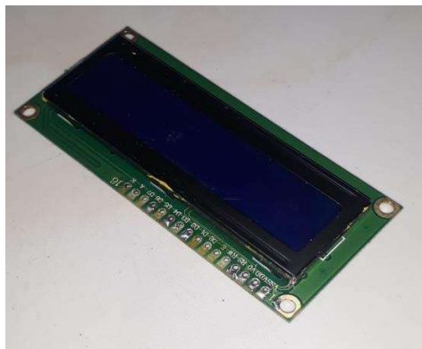
Gambar 2. 4 Struktur dasar LCD Sumber : Data Penelitian (2022)
