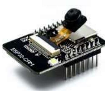
**Gambar 2. 6** Mikrokontroler ESP 32 Cam
