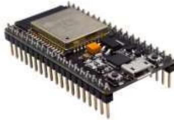
**Gambar 2. 5** Mikrokontroler ESP 32
