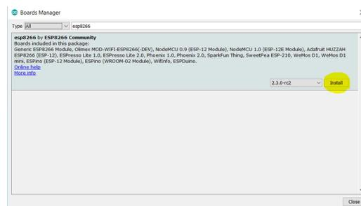
**Gambar 2.5** Mengunduh *Board* ESP8266
