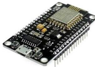
**Gambar 2.1** Bentuk fisik NodeMCU V3
