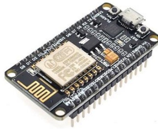
Gambar 2.14 Modul ESP8266 NodeMCU Sumber : (Dalvi, Salahuddin, 2016)
