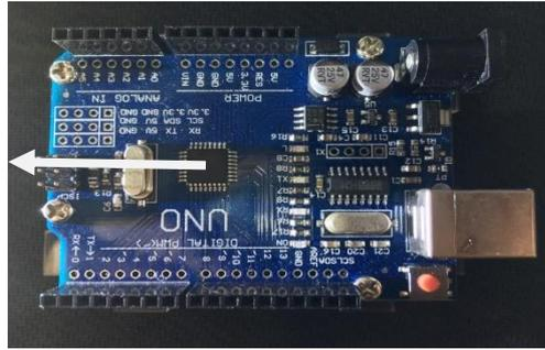
**Gambar 2.1** Mikrokontroler pada Board Arduino Uno
