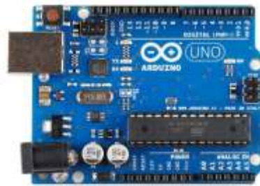
Gambar 2.1 Mikrokontroller Ardunino Uno R3
