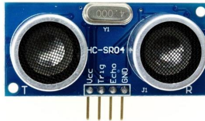
Gambar 2.4 Sensor HC-SR04 Sumber: (Kadir, 2015 :200)
