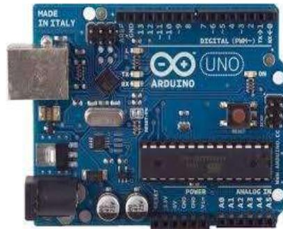
Gambar 2.1 Mikrokontroler Arduino Uno
