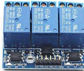
**Gambar 2.5.** Module Relay
