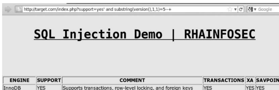
Gambar 2.2 True result hasil dari Blind SQL Injection Sumber: Buku Ethical Hacking and Penetration Testing Guide, p. 358
