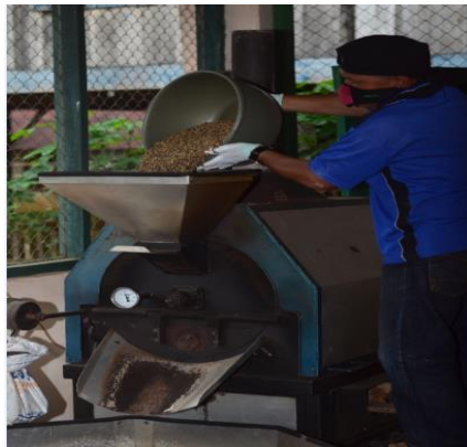
Gambar 2. 4 Mesin Sangrai (Dokumentasi CV Kopi Cahaya Semende)
