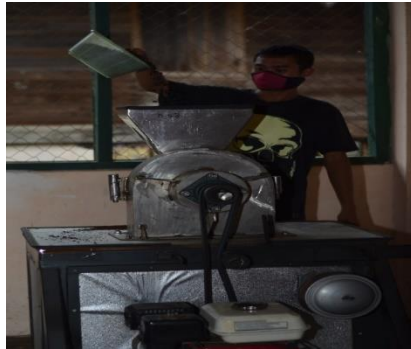
Gambar 2. 5 Mesin giling biji kopi (Dokumentasi CV Kopi Cahaya Semende)
