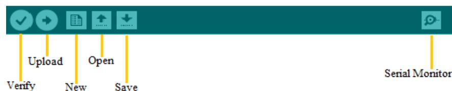
**Gambar 2.8 Toolbar pada Arduino IDE**
