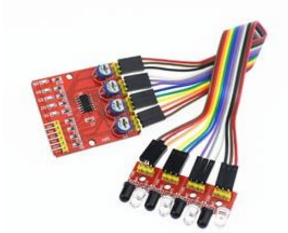
**Gambar 3. 2** Empat *Channel* sensor IR
