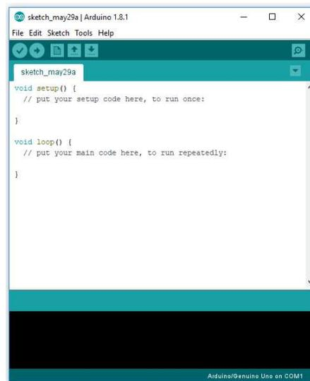
**Gambar 2.5** Tampilan antarmuka *Arduino IDE*
