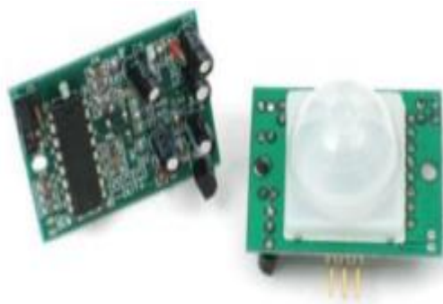
Gambar 2.5 Bentuk Fisik Passive Infra Red Sumber: (Desyantoro et al., 2016)
