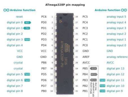
Gambar 2.1 Pin ATmega 328 pada arduino
