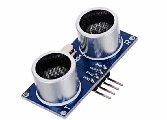
Gambar 3. 2 Ultrasonik HC-SR04 Sumber: Data Olahan Penulis (2018)
