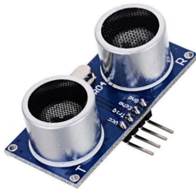
Gambar 3. 2 Ultrasonik HC-SR04 Sumber: Data Olahan Penulis (2018)
