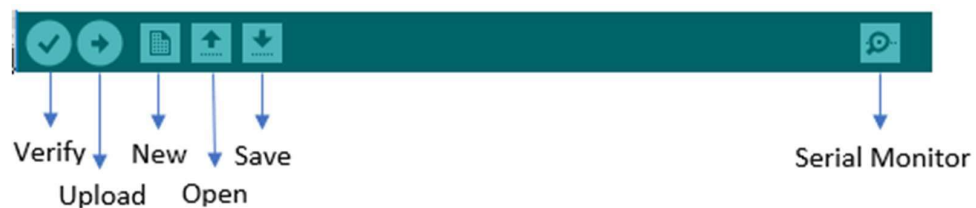
Gambar 2. 4 Tampilan Toolbar IDE Arduino 1.8.5 Sumber: Data Olahan Penulis (2018)
