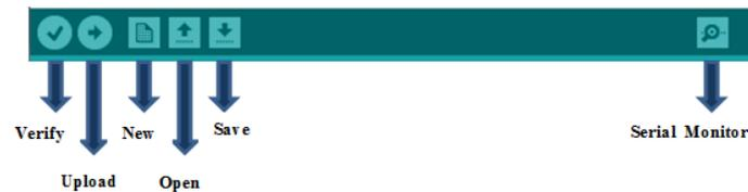
**Gambar 2. 6 Toolbar Arduino IDE**
