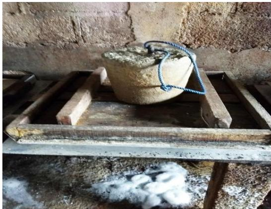
**Gambar 2. 5** Proses Pengepressan dan Pencetakan Tahu
