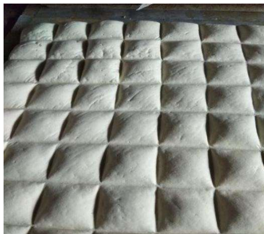
Gambar 2. 6 Hasil Pengepressan Tahu
