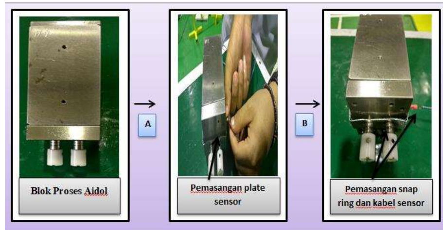
Gambar 4.15 Pemasangan Plate, Snap Ring dan Kabel Sensor
