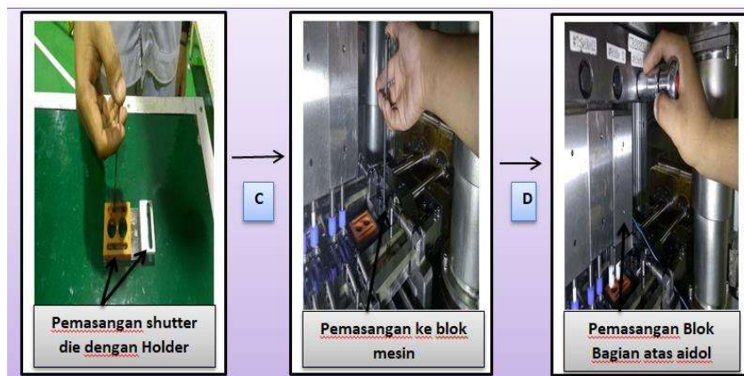
Gambar 4.16 Pemasangan Shutter Die dan holder ke Blok Mesin
