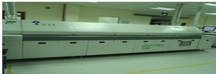
**Gambar 2.6** Mesin Reflow
