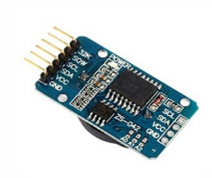
**Gambar 2.5** Sensor RTC DS3231
