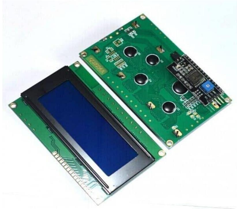
**Gambar 2.6** LCD 20x4 dengan Module I2C
