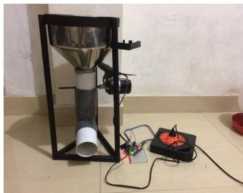
**Gambar 3.22** Pengujian Rangkain *Hardware* ke *Relay* dan Motor Ac
