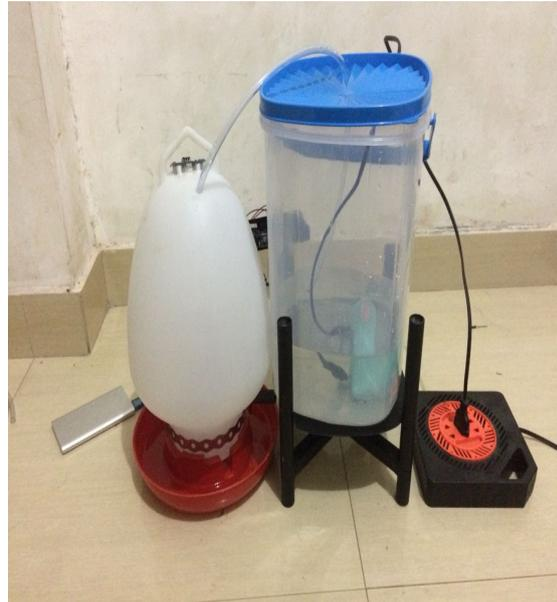
**Gambar 3.26** Pengujian Rangkai *Hardware* Ke *Prototype* Pemberi Minum Ayam secara keseluruhan
