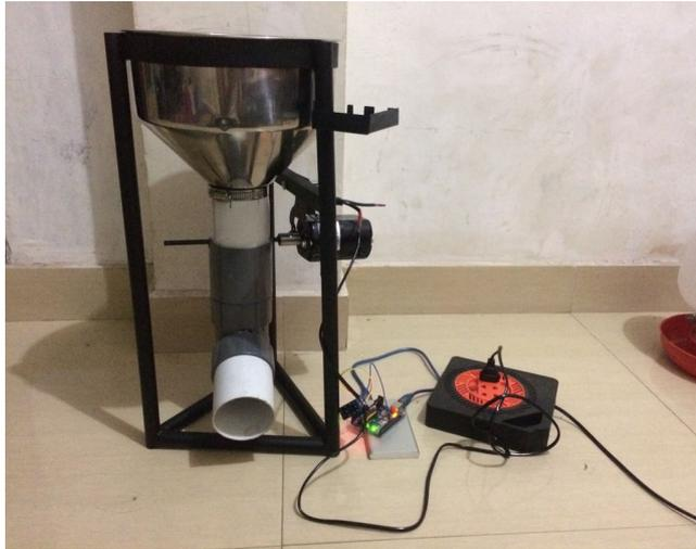
**Gambar 3.28** Pengujian Rangkain IDE *Software* Arduino ke *Relay*
