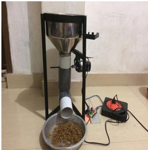
**Gambar 3.29** Pengujian Rangkai IDE *Software* Arduino Ke *Prototype* Pemberi Pakan Ayam secara keseluruhan
