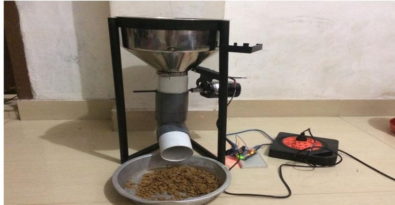
**Gambar 3.23** Pengujian Rangkaian *Hardware* Ke *Prototype* Pemberi Pakan Ayam secara keseluruhan
