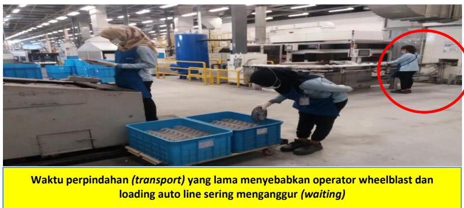
Gambar 1. 1 Transfer part dari wheelblasting ke Spray (Sumber: Arsip PT. Philips Industries Batam)
