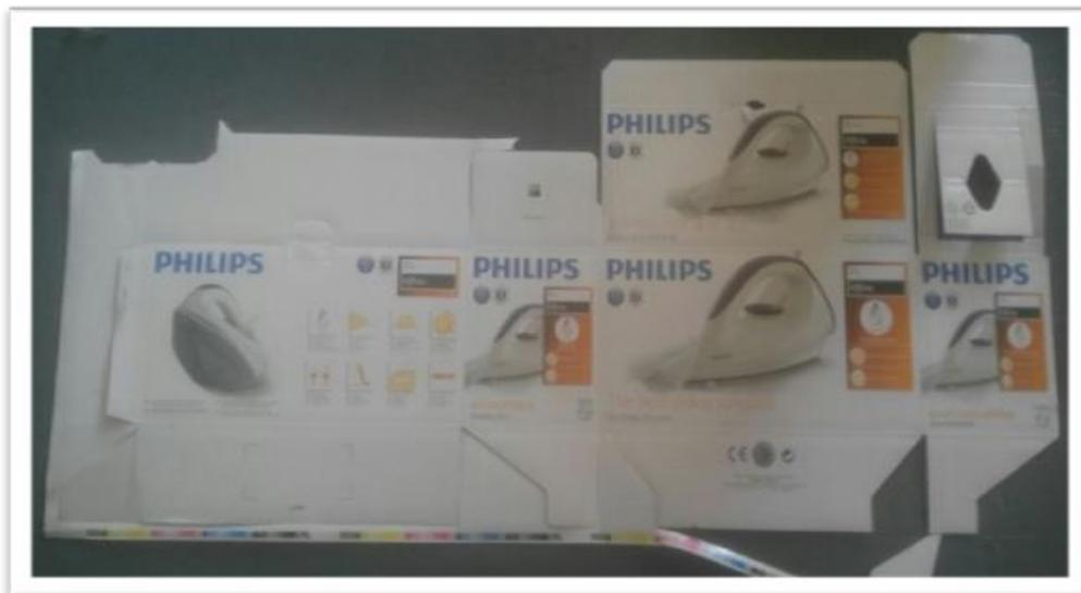
Gambar 2. 8 Potongan tidak Putus (*Uncompleted Cutting*)
