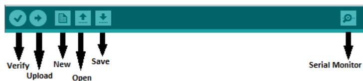
**Gambar 2.7** *Toolbar* Arduino IDE
