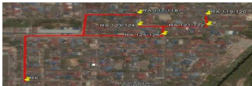
Gambar 3.2 Jaringan Lokal Akses Tembaga (Sumber: Telkom Akses)
