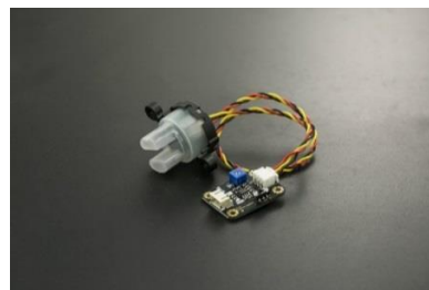
Gambar 2. 12. Sensor Kekeruhan SEN0189
