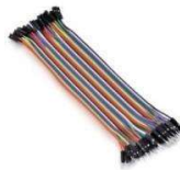
Gambar 3. 8. Kabel Jumper Sumber : (Dokumentasi Pribadi, 2023)
