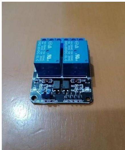
**Gambar 2.3** Module Relay
