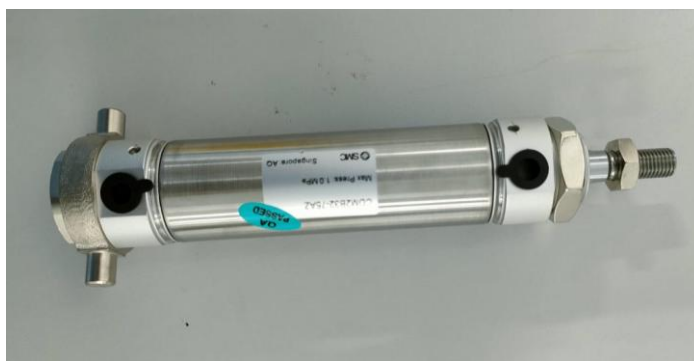
Gambar 2.6 Salah Satu Jenis Double Acting Cylinder Yang Digunakan Pada Bidang Unit Mesin PT JMS Batam
