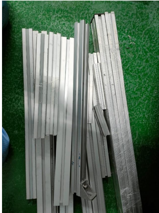
Gambar 2.1 Aluminium Profile Dan Ragam Variasi Bentuk Yang Digunakan Sebagai Komponen Rangka Utama Penyusun Mesin
