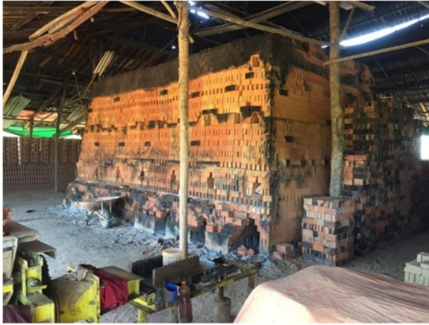
Gambar 3. Batu Bata Setelah Dibakar Tersusun Ditunggu Pembakaran
