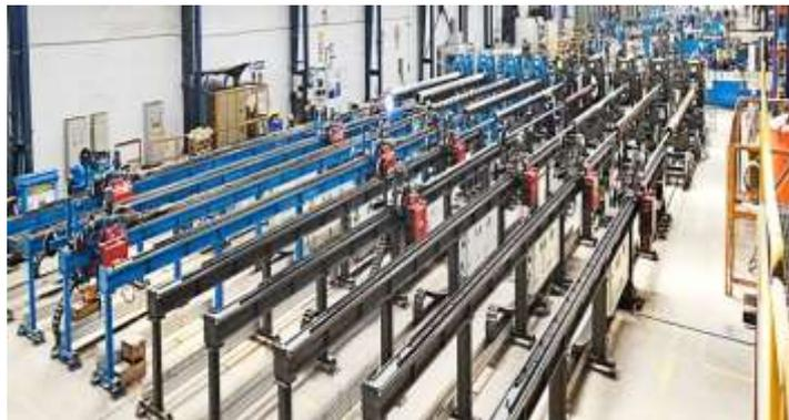
**Gambar 2. 1** Mesin las overlay
