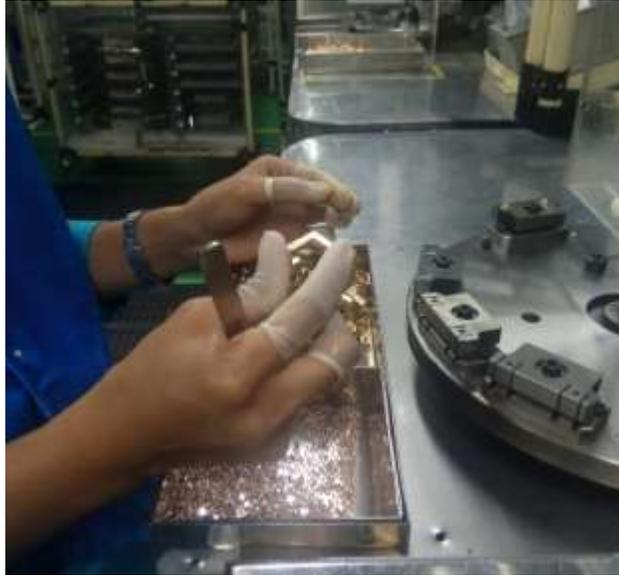
**Gambar 2. 1** Peletakan Rivet
