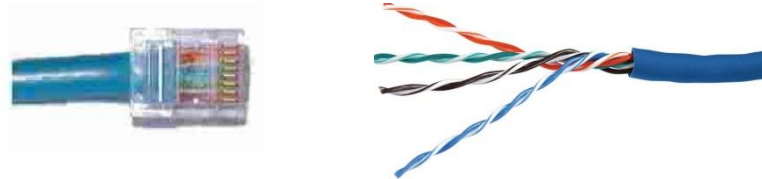
Gambar 2. 2 Kabel UTP dan konektor RJ 45
