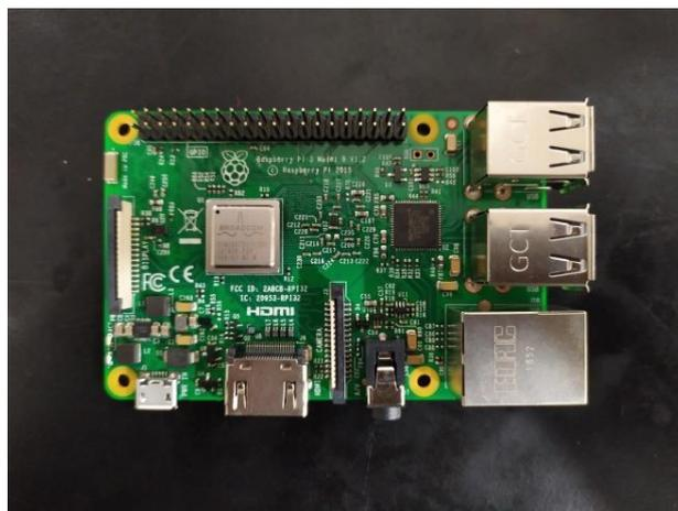
**Gambar 2.1** Tampilan keseluruhan Raspberry Pi 3 model B+
