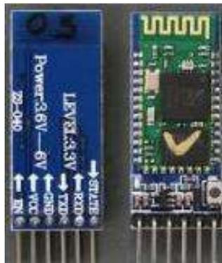
**Gambar 2. 2** Modul dan konfigurasi PIN
