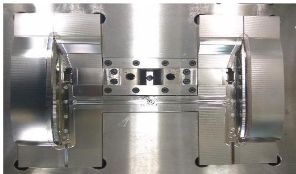
**Gambar 2.5** Cetakan (*Mould*) Mesin *Injection Reflector*
