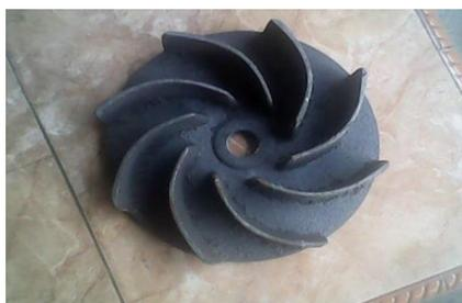
**Gambar 2.11** *Impeller*
