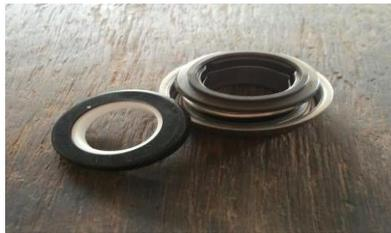
**Gambar 2.13** *Seal Pompa*
