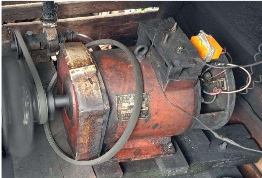
Gambar 2.2 Generator DC Sumber: (Olahan Data)
